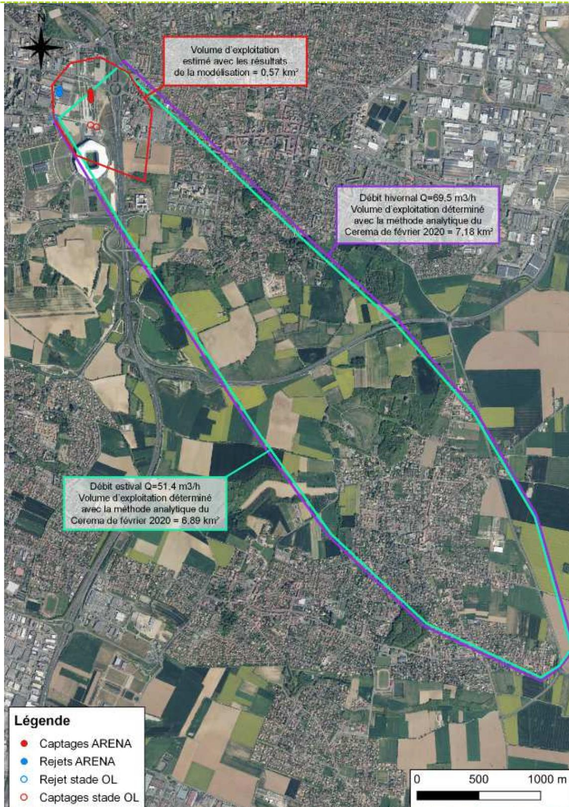
Figure 12 : Comparaison du volume d'exploitation évalué à partir de la modélisation et de ceux déterminés avec la méthode analytique du CEREMA
